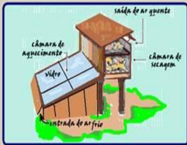
Estufa caseira para secagem de alimentos mostrando o interior da câmara de aquecimento e o interior da câmara de secagem onde são colocados os alimentos
