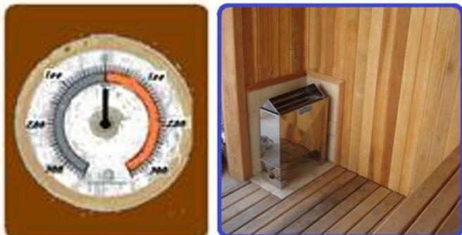
Constituído por duas lâminas bimetálicas com metais diferentes, e soldadas uma com a outra, conforme a figura.
