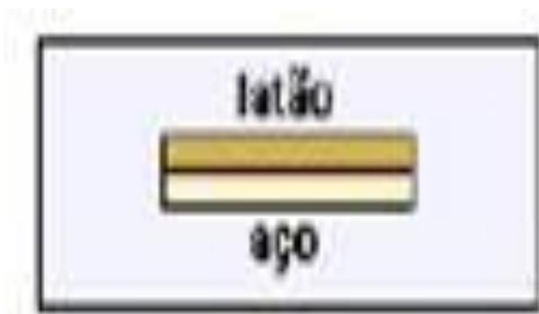
O coeficiente de dilatação térmica linear do latão é maior que o do aço. A lâmina bimetálica é aquecida a uma temperatura acima da ambiente e depois resfriada até uma temperatura abaixo da ambiente. A
