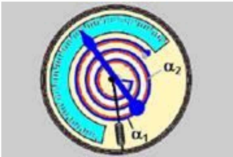
Um ponteiro está acoplado à espiral cuja extremidade interna é fixa. A lâmina é constituída por dois metais, fortemente ligados, com coeficientes de dilatação linear distintos,  $\alpha_1$  e  $\alpha_2$ , indicados, respectivamente, pelas regiões azul e vermelha da espiral.
